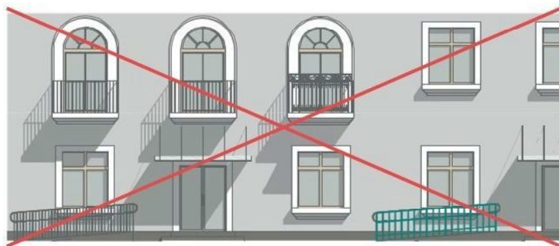
Плохо. Ограждения привлекают к себе излишнее внимание и не сочетаются друг с другом по форме и цвету. В ограждении балкона используется псевдоисторическая ковка
