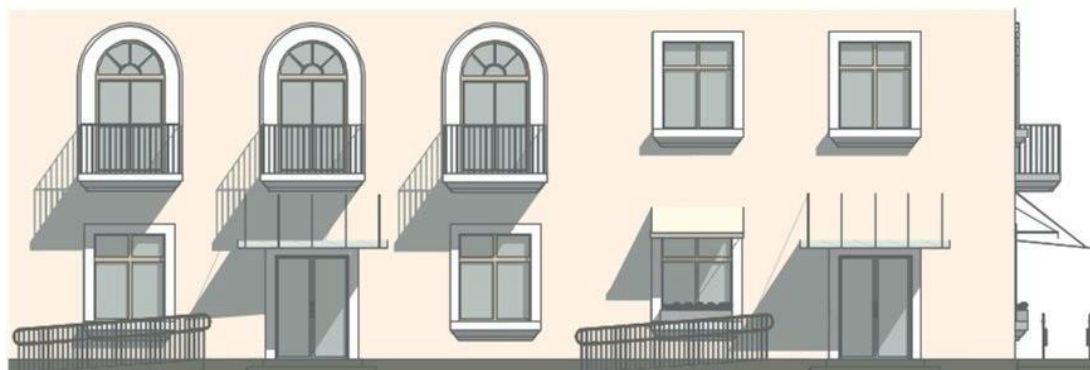
Хорошо. Пандусы выполнены из одинаковых материалов и окрашены в один цвет, габариты соответствуют требованиям СП 59.13330.2016
